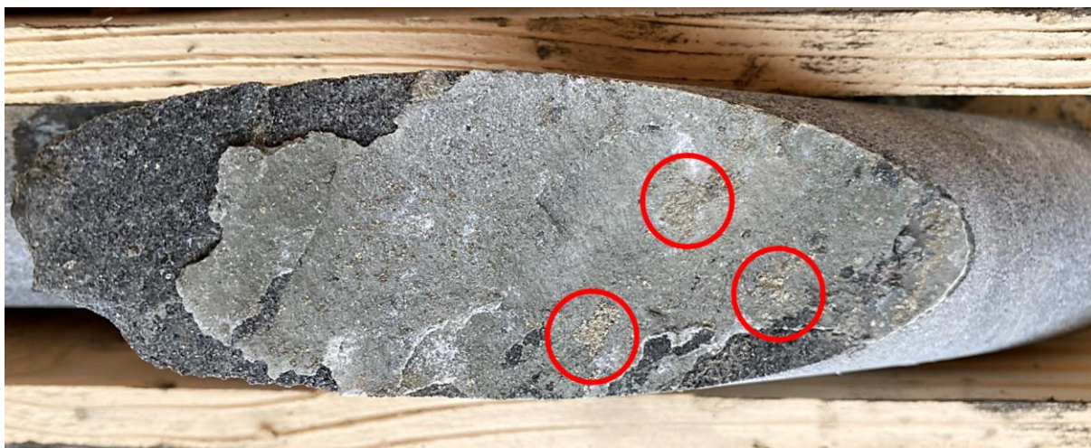
Figur 9: Synlig pyritt (merket med rødt) er ofte registrert som sprekkefylling, der kismineralene ofte er sammenvokst med kalkspat.
