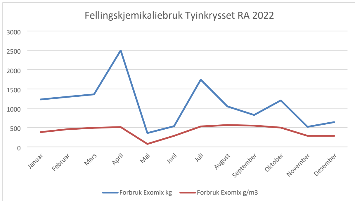
Figur 15 Fellingskjemikaliebruk for Tyinkrysset renseanlegg 2022
