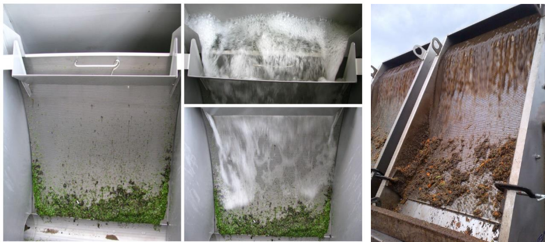
Figur: Forfiltrering av vaskevann med skjermfiltre (Kilde HMGA, Canada)
