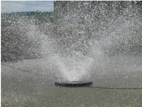
Figur: Fontenelufting av vaskevann for grønnsaker (HMGA, Canada)
