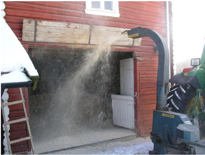
Flising på gardsvarmeanlegg i Elverum (2004)
