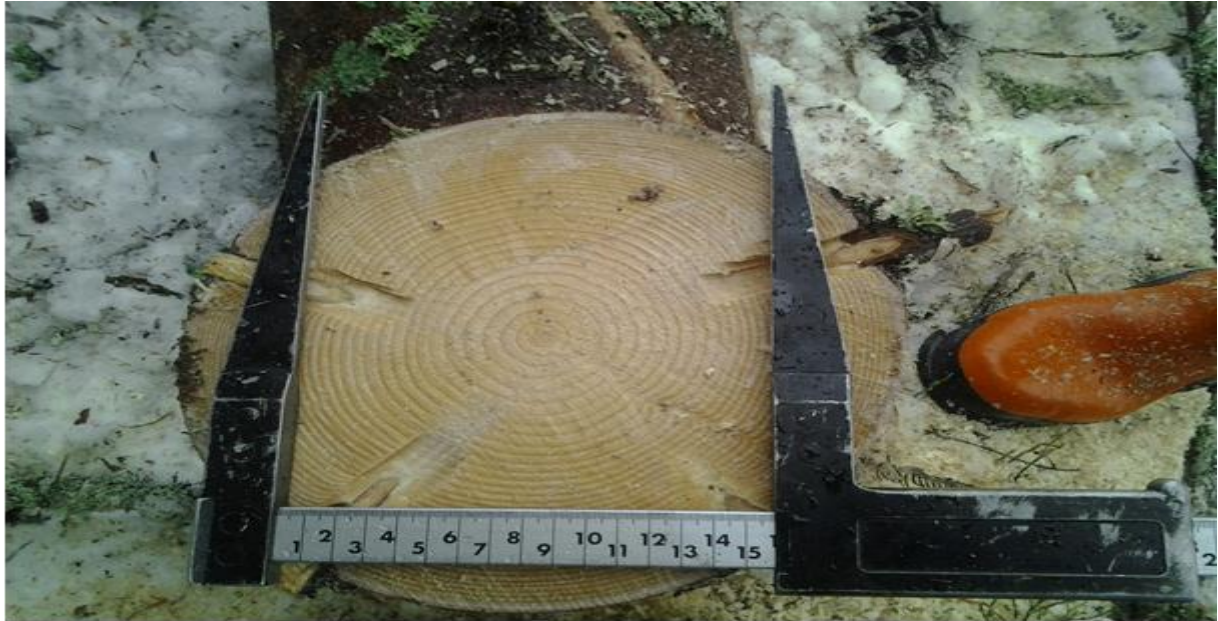
Bilde 3. Årringmønster og friskkvistblokk på 150mm i treseksjon 2 – stokk nr. 2 - på DGV treet, det vil si det treet som har en brysthøyde diameter som plasserer det som middel treet i bestandet.
