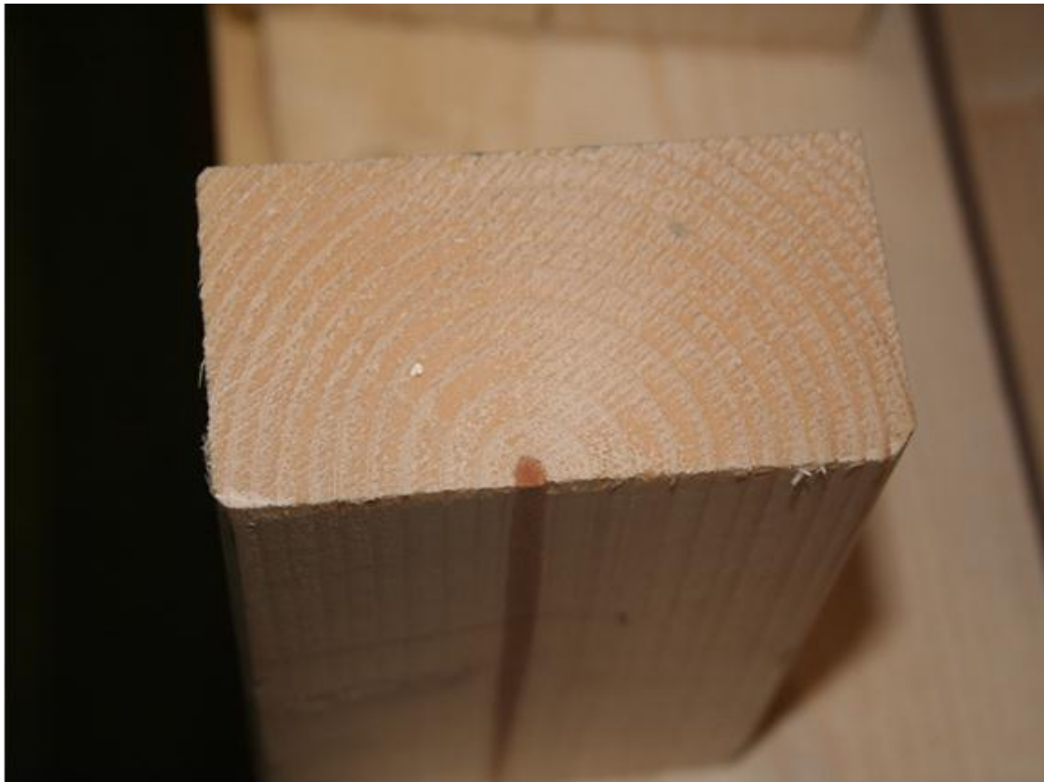
Bilde 6. Årring mønsteret i tverrsnittet av plank 49x198mm i fra prøveskuren på Moelven Granvin. Tverrsnittet er representativt for Vestlandsgrana .
