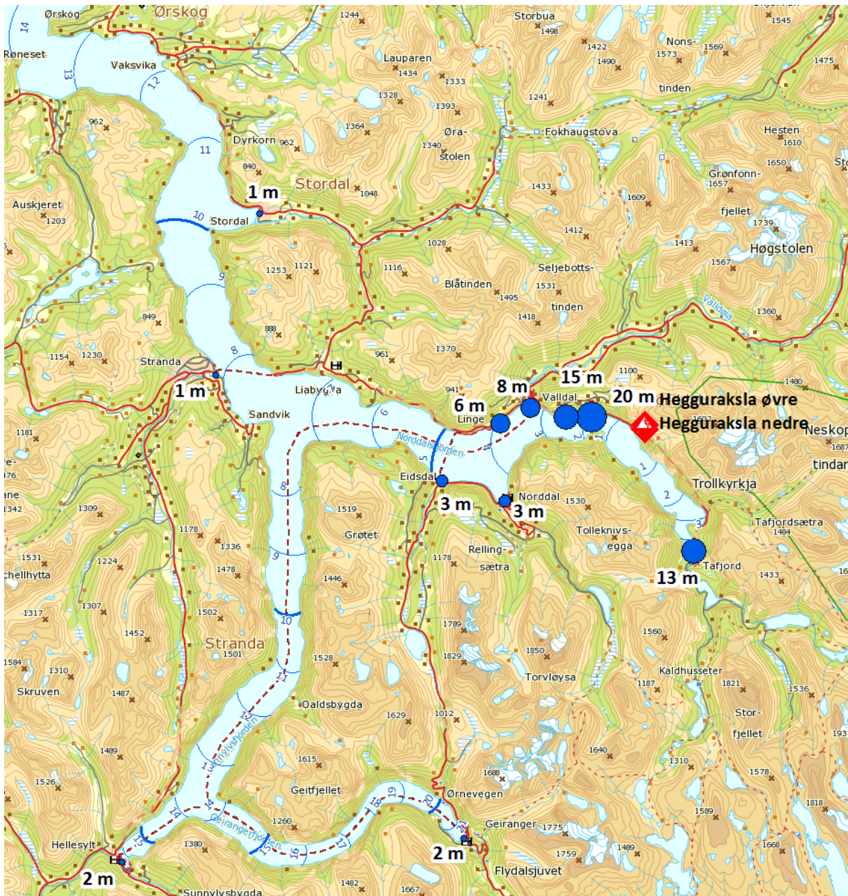
Figur 2-5 Kartet viser Hegguraksla og estimerte oppskyllingshøgder i Storfjordbassenget med eit skred på 3,5 mill. m 3 . Estimert tid for første bølge er vist med blå linjer i fjordbassenget.
