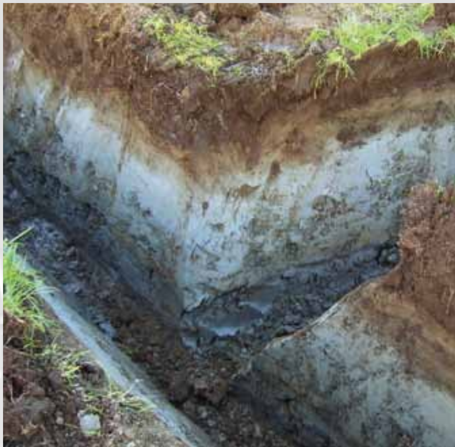
Kunnskap om jordart er utgangspunkt for valg av grøfteavstand, filter med mer.
