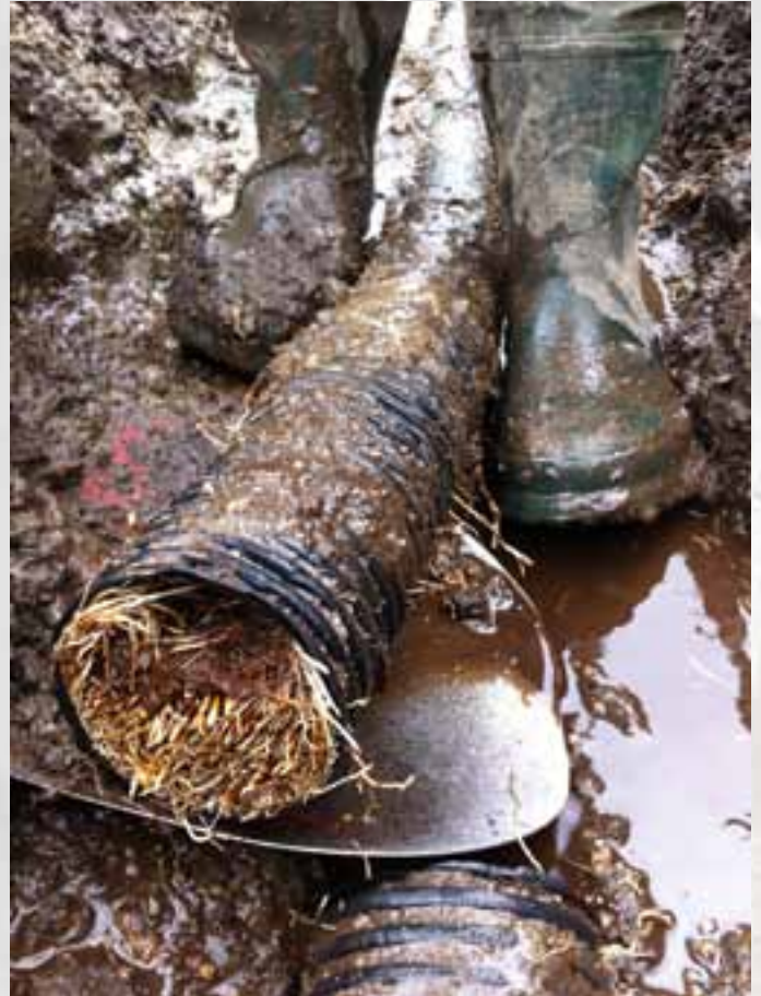
Rotinntrenging i drensøyr. Foto Ståle Hustoft.
