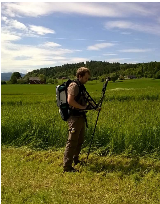
Jakob Geipel måler reflektans med håndholdt ASD-FieldSpec3 i felt på Kvithamar. Foto: Anne Kjersti Bakken
