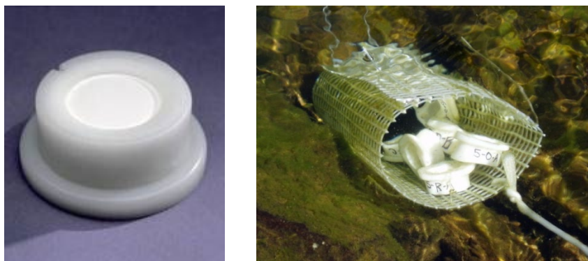
Figur 9. DGT (Diffusive Gradients in Thin films) – passiv prøvetakere som akkumulerer metaller i vann (Foto: NIVA).
