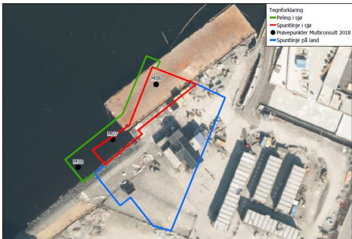
Figur 1. Utsnitt fra oversiktstegning 1:1000 (10217096-RIGm-TEG-001, vedlegg 2 til søknadsskjema). For flere detaljer vises det til oversiktsplaner og profil i vedlegg B-D.
