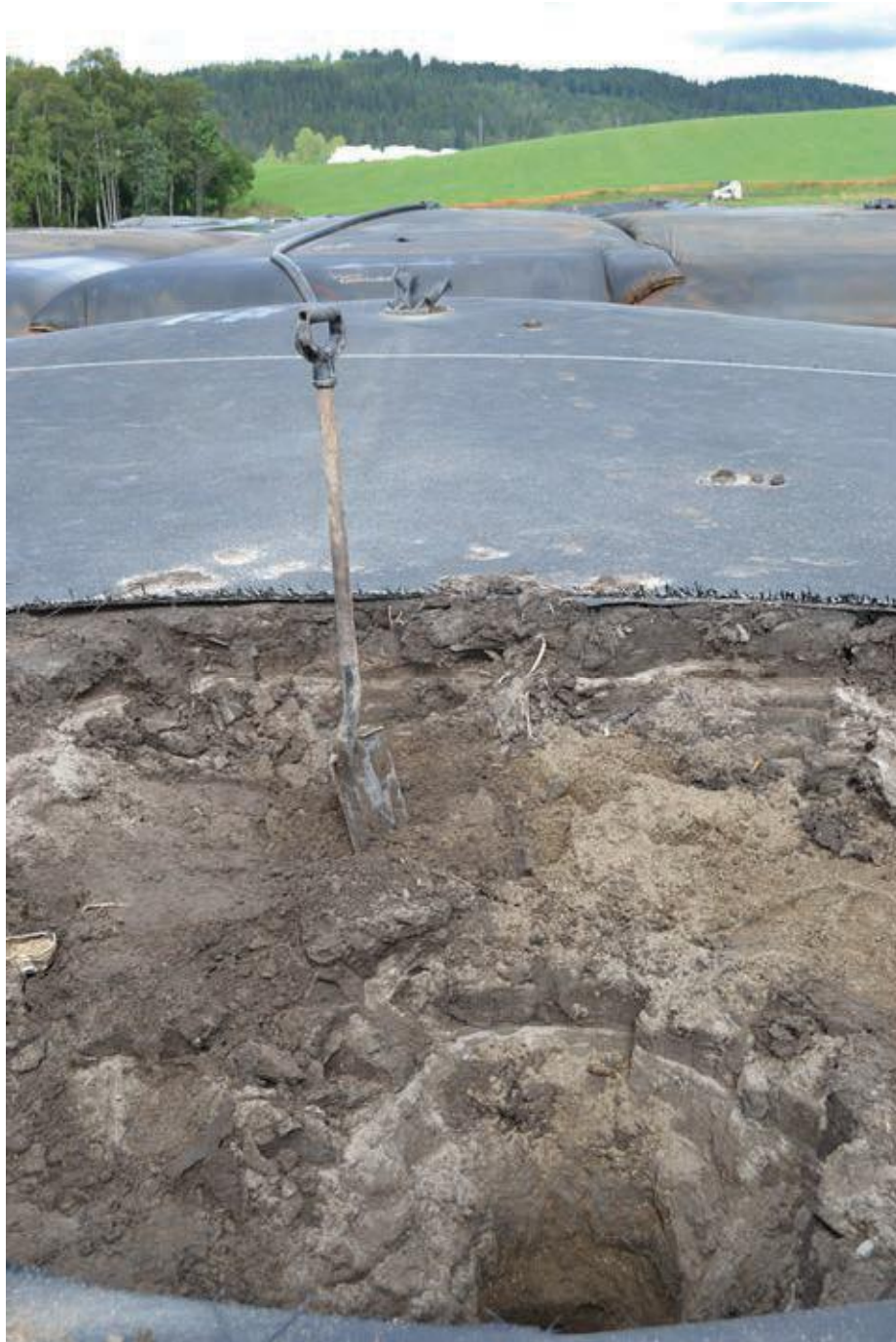
Figur 4. Geotube fylt med blanding av sand og siltig sand/sandig silt (Foto: Trond Knapp Haraldsen). Disse massene skal anvendes på jordene.
