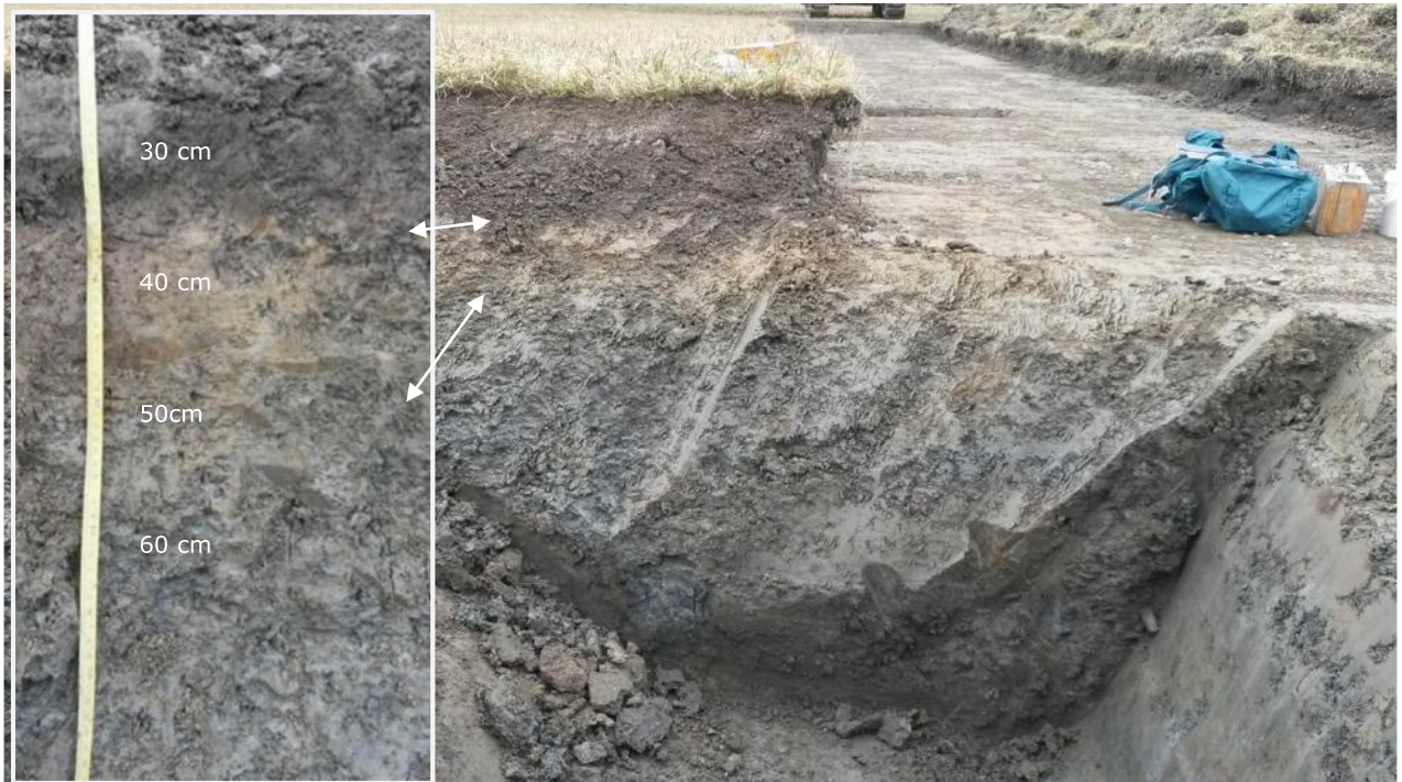
Figur 3-8: 1) Deler av rigg- og avvanningsområde O2 hvor det planlegges utplassering av Geotuber. Felt A1 vil ligge til venstre i bildet, A2 til høyre, og A3 til høyre for høyden bakerst (sørvest) i enga (A3 er ikke med på bildet). Nord mot høyre i bildet. 2) Jordprofil fra østlig del av området, ved A1-A2. (Foto: Trond Knapp Haraldsen)
