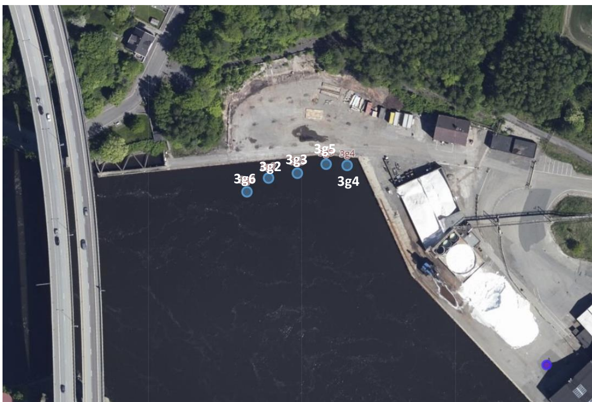
Figur 1. Stasjoner som ble prøvetatt med kjerneprøvetaker. «Saltbinger» til høyre på bildet hvor det ble forsøkt å ta kjerneprøver langs kaifronten. Kilde kystkart.no
