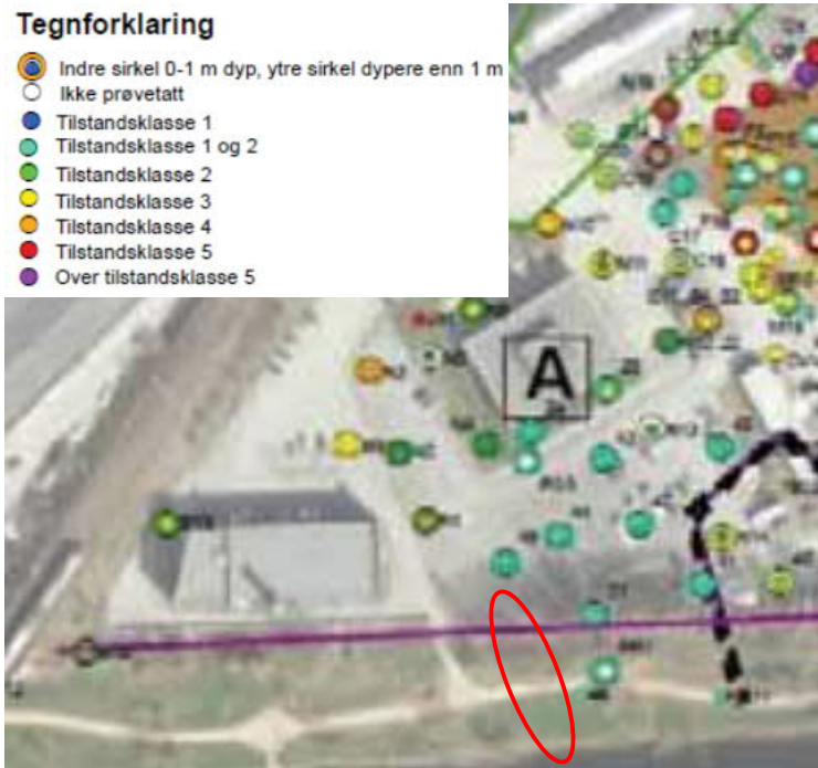
Figur 3-0-1: Utsnitt fra tiltaksplan for forurenset grunn for nytt sykehus i Drammen /1/. Figuren viser høyeste påviste tilstandsklasse for forurenset jord iht. TA-2553/2009. Rødt omriss viser aktuelt område for graving for sjøvannsledningen.
