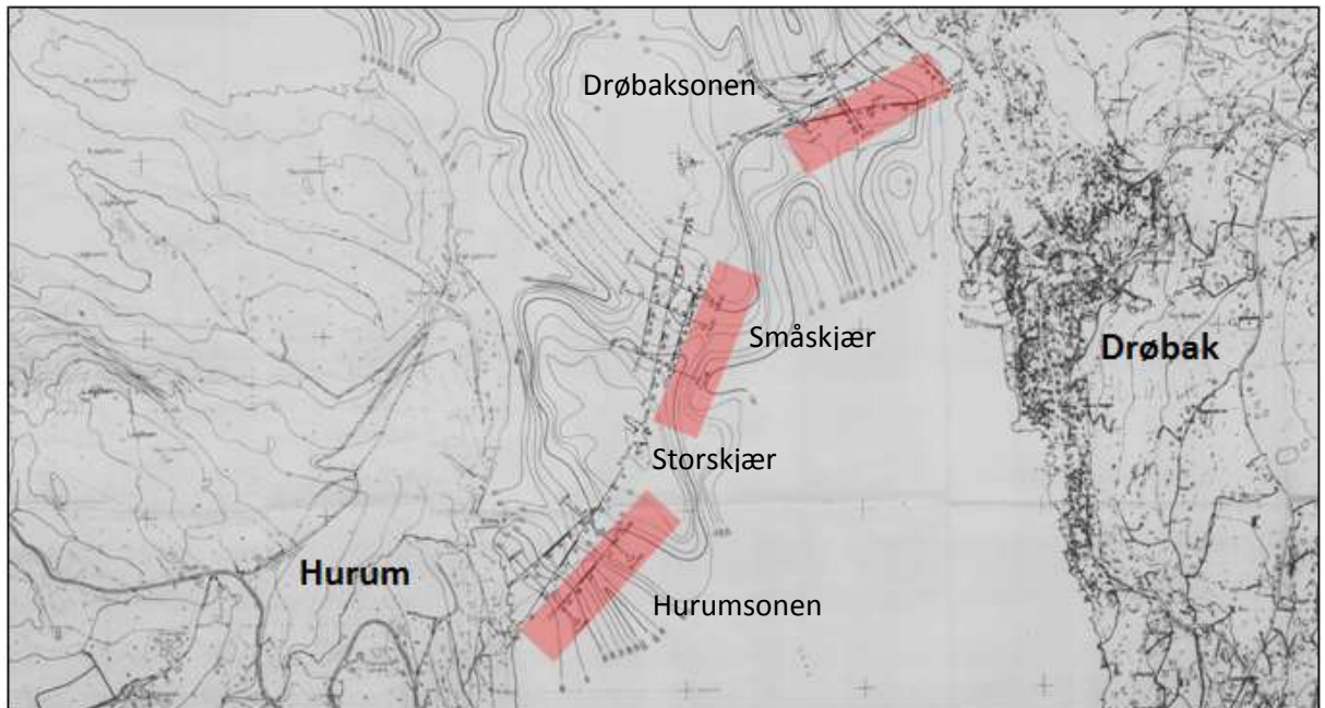
Figur 3-16: Områder for supplerende refraksjonsseismikk (rød skravur), tegnet inn på gammelt kart med tidligere utførte refraksjonsseismiske undersøkelser i Oslofjorden.
