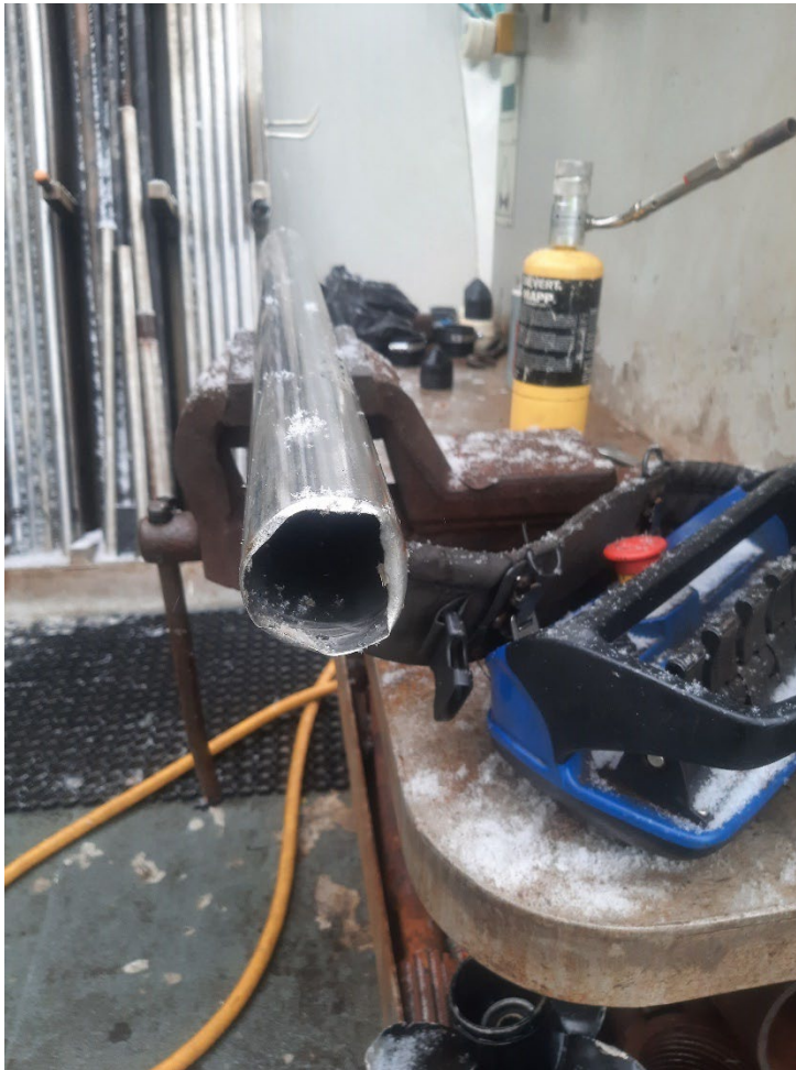
Figur 3. Bøyd ende av prøvesylinder etter møte med stein/faste masser, i forsøk på å hente opp sedimenter ved miljøprøvepunkt nr. 3 i elva.
