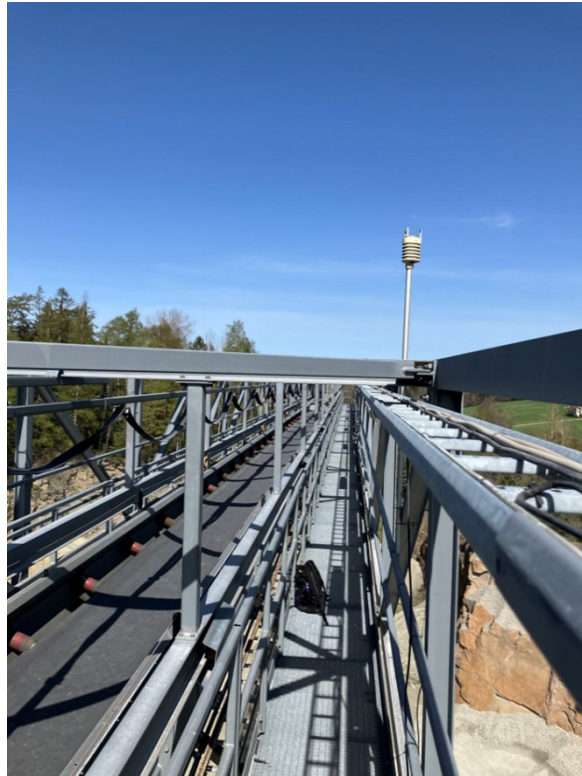
Figur 14: Vaisala værstasjon plassert på gangbroa øverst ved anlegget. Instrumentet har blant annet en sonisk vindmåler med tre «pinner» øverst på instrumentet der det er plassert et system av høyttalere og mikrofoner. Når lyd sendes ut fra en høyttaler vil det være en ørliten forskjell mellom tidspunktene lyden treffer de to mikrofonene ca. 10 cm unna. Tidsforskjellene brukes så til å regne ut vindhastighet og -retning i to dimensjoner.
