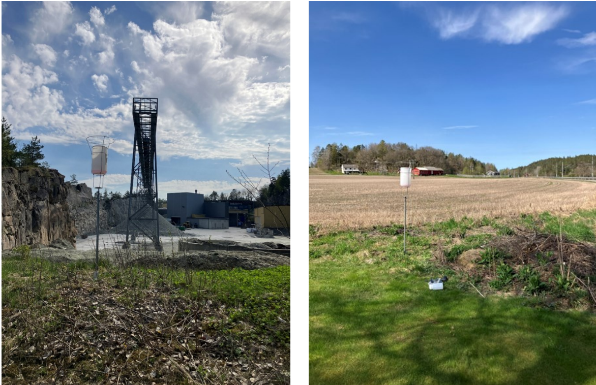
Figur 16: NILU støvsamlere som ble utplassert kun for dette prosjektet. En like nord for anlegget (venstre) og en plassert et stykke mot sør (høyre). I tillegg ble målingene fra de tre eksisterende støvsamlerne fra Hardanger Miljøsenster benyttet.
