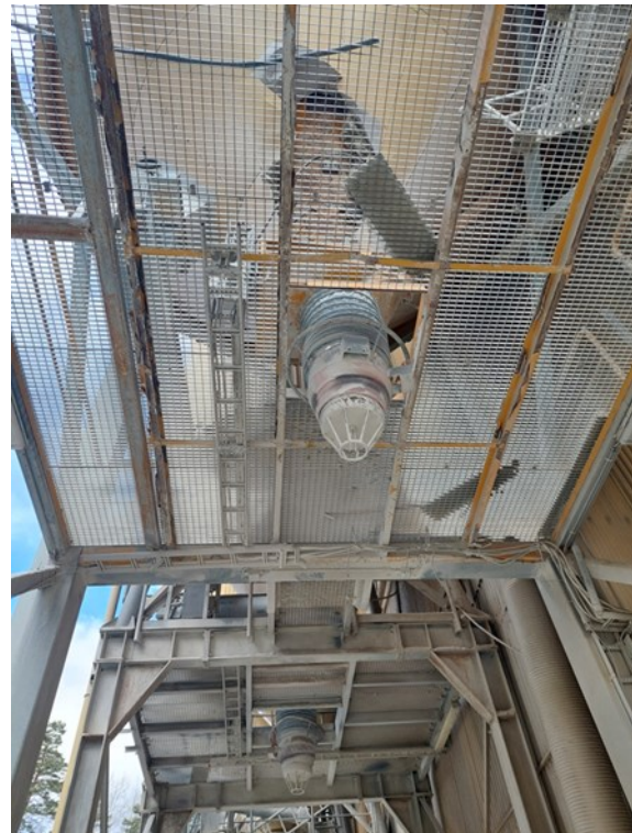
Figur 3: Lagringstanker for finmalt glasstøv. Lastebiler kan kjøre inn under tankene og fylle finmalt glass for frakt til anlegget i Skjåk (venstre bilde). Finmalt glass tappes gjennom egne tappekraner (høyre bilde).
