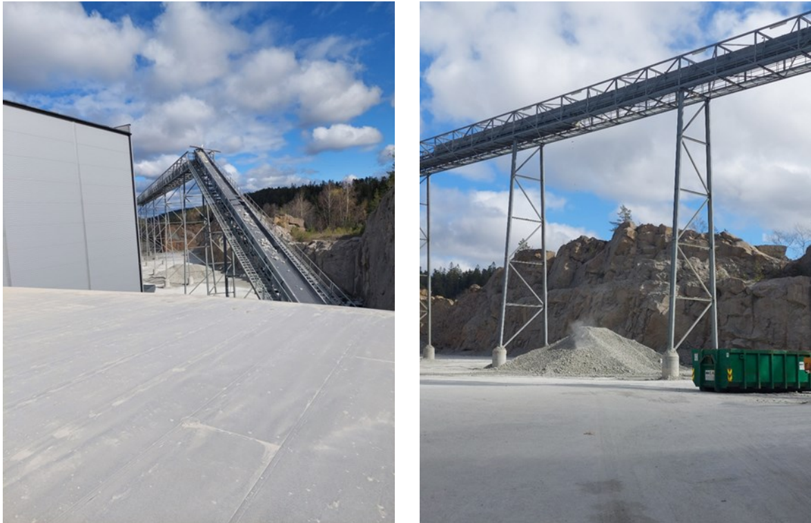
Figur 6: Åpent transportbånd (venstre bilde tatt fra taket av produksjonshallen) som bringer ferdig skumglass bort til lagerplassen der det faller om lag 20 m ned. Høyre bilde viser utslipp av synlig støv hver gang skumglassbiter faller ned og treffer haugen.
