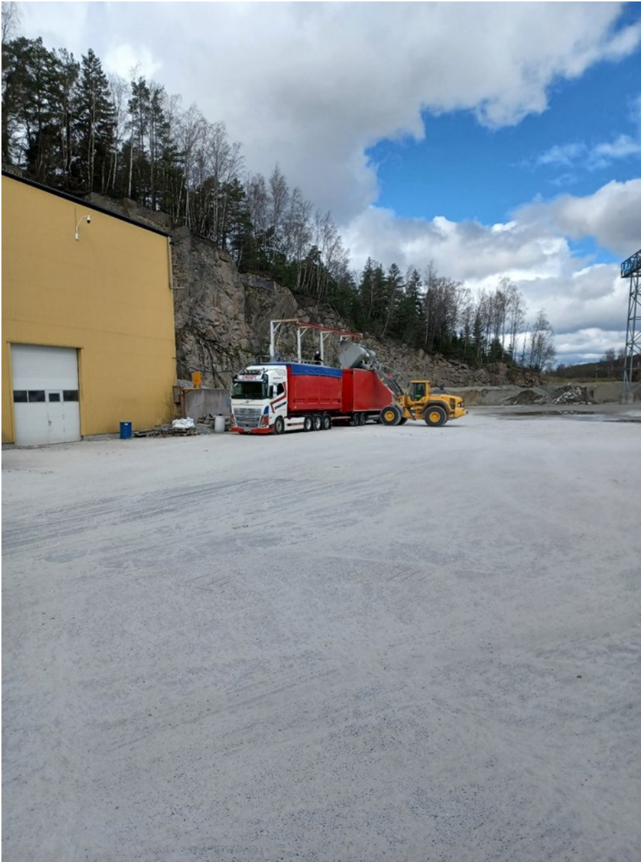
Figur 7: Ferdig skumglass bringes fra mellomlager (Figur 6) og lastes på trailer ved hjelp av hjullaster. Lasten dekkes til før utkjøring til kunde.
