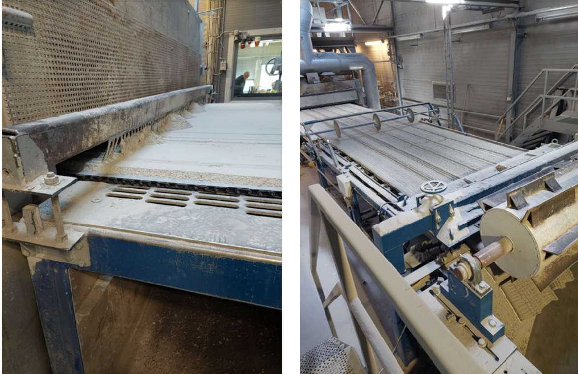
Figur 4: Produksjon av skumglass. En blanding av finmalt glass og silisiumkarbid legges i et tynt lag på et bånd (venstre bilde) som så transporteres sakte gjennom en ovn og kommer ut som store flak av skumglass (høyre bilde).
