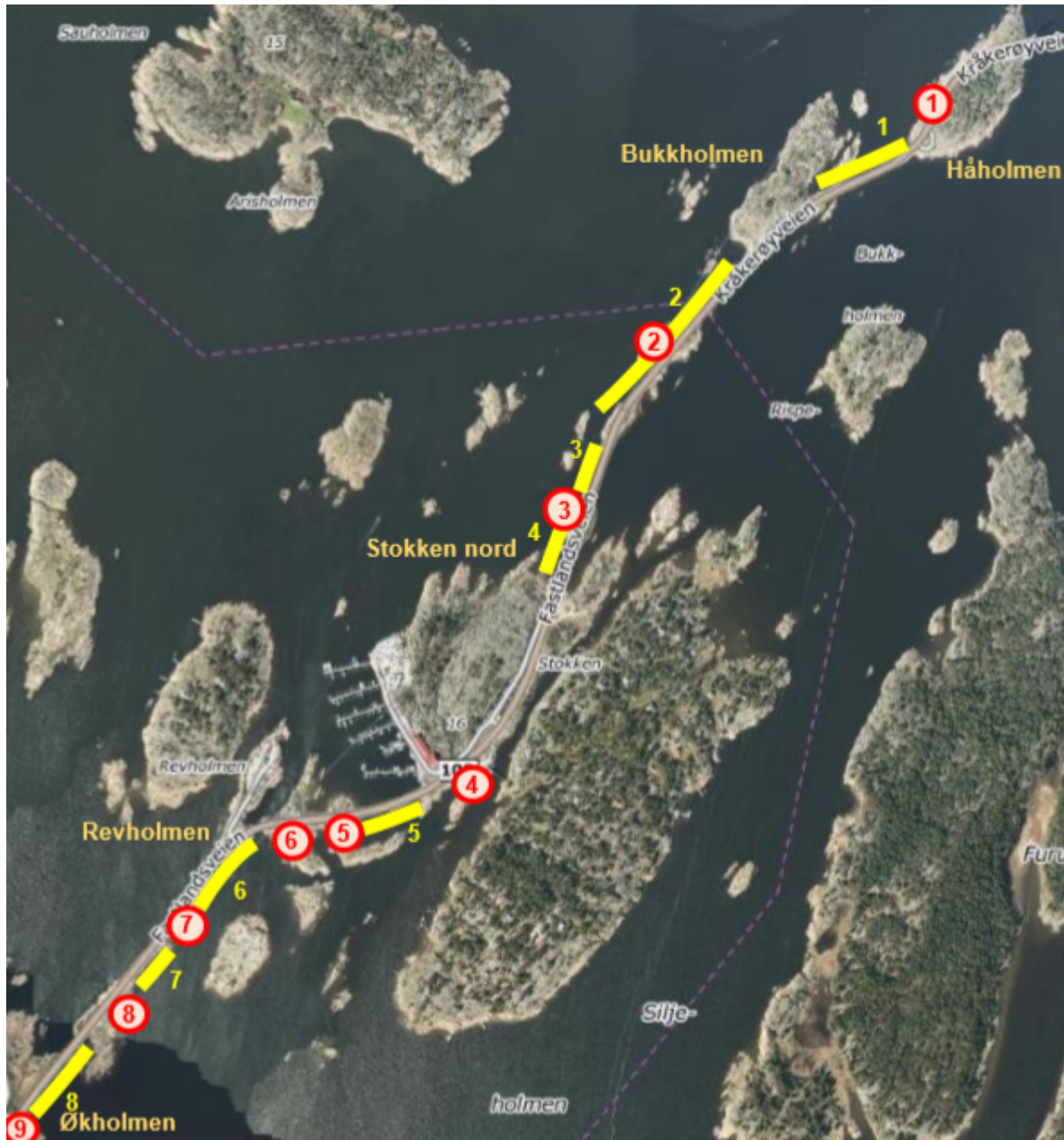
Figur 1. Oversiktskart over entreprisen EP1.1 – Føringsvei for kabel og G/S-veg Håholmen – Økholmen. Skissert plasseringer av utfyllinger i sjø er markert med gule striper. Røde sirkler og tall viser sprengningslokalitetene.
