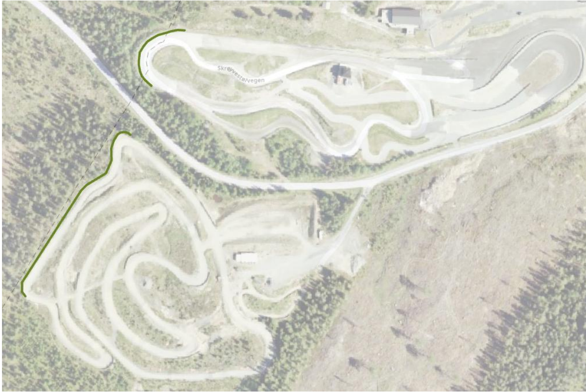
Figur 8 - Banen for Bilcross/Rallycross/Crosscart/Shortcar øverst på bildet og Motocross nederst på bildet. Den vurderte plasseringen av støyskjermene er markert med to grønne streker. Bakgrunnsbildet er hentet fra ©norgeskart.no.
