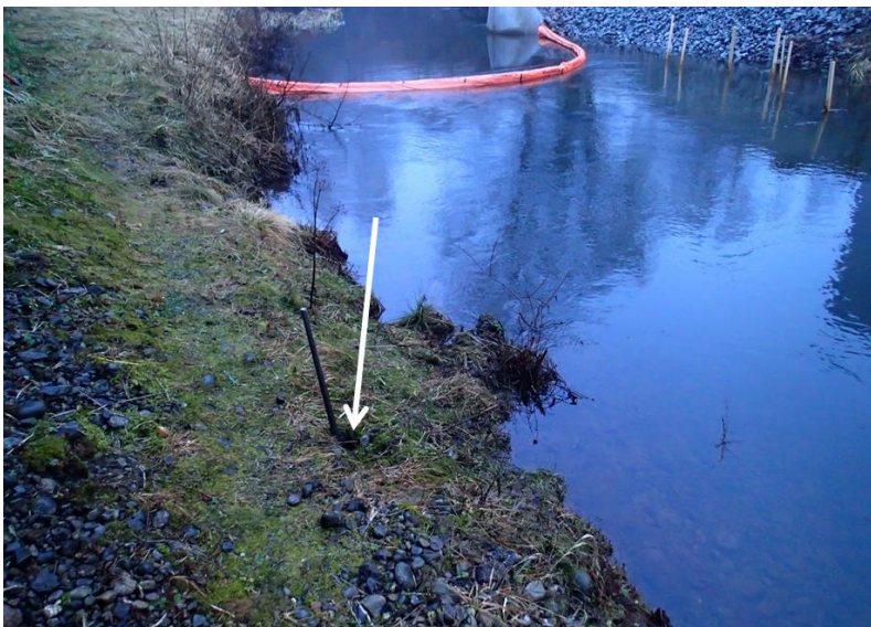
Figur 22. Prøvetaking av massene i BP 6, på slakteriet Furuset AS, den 9. januar 2014. Borepunktet er markert med hvit pil.
