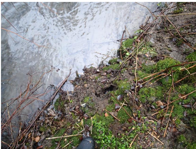
Figur 29. Prøvetaking av massene i BP 12, på slakteriet Furuset AS, den 9. januar 2014. Det ble ikke gjort noen observasjoner av tegn til olje i massene nedenfor borepunktet.
