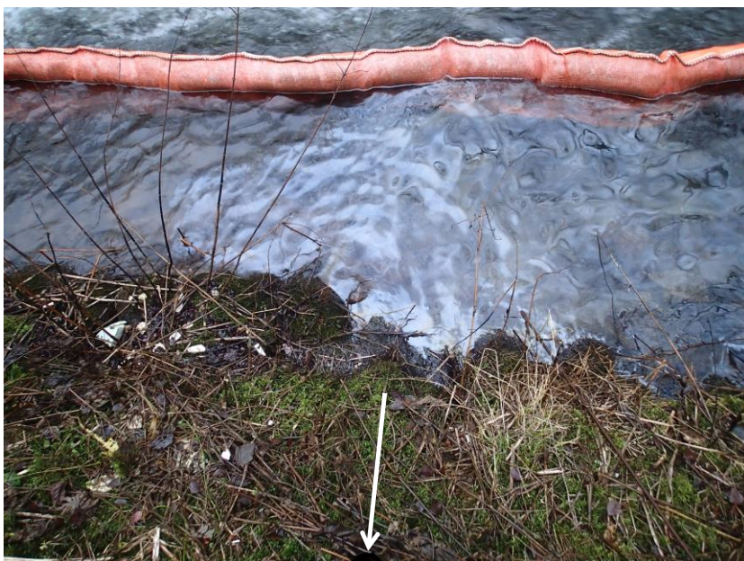
Figur 27. Prøvetaking av massene i BP 10, på slakteriet Furuset AS, den 9. januar 2014. Borepunktet er markert med hvit pil. Oljefilmen som siger ut av massene nedenfor borepunktet, er synlig i bildet.
