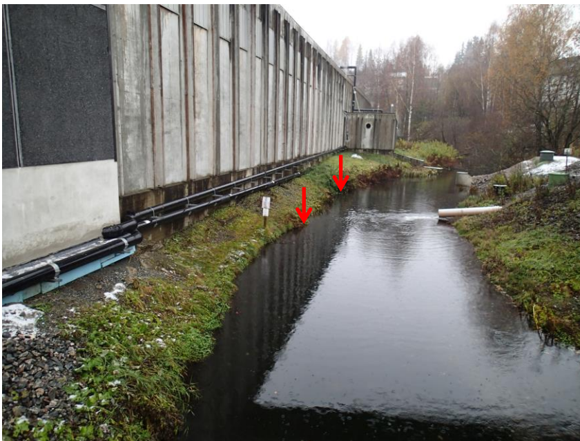
Figur 10. Det ble også observert noe lekkasje av olje ut fra grunnen i elvebredden mellom de to røde pilene på baksiden av bygget til Furuset AS.
