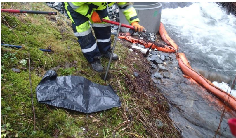
Figur 26. Prøvetaking av massene i BP 9, på slakteriet Furuset AS, den 9. januar 2014. Det ble observert olje i jordmassene ved grunnvannsstand/elvens overflate umiddelbart til høyre for borepunktet (mot elven).
