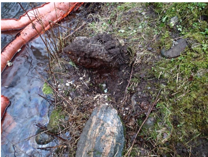
Figur 28. Prøvetaking av massene i BP 11, på slakteriet Furuset AS, den 9. januar 2014. Oljefilmen som siger ut av massene under prøvetakingen kan tydelig sees i bildet.
