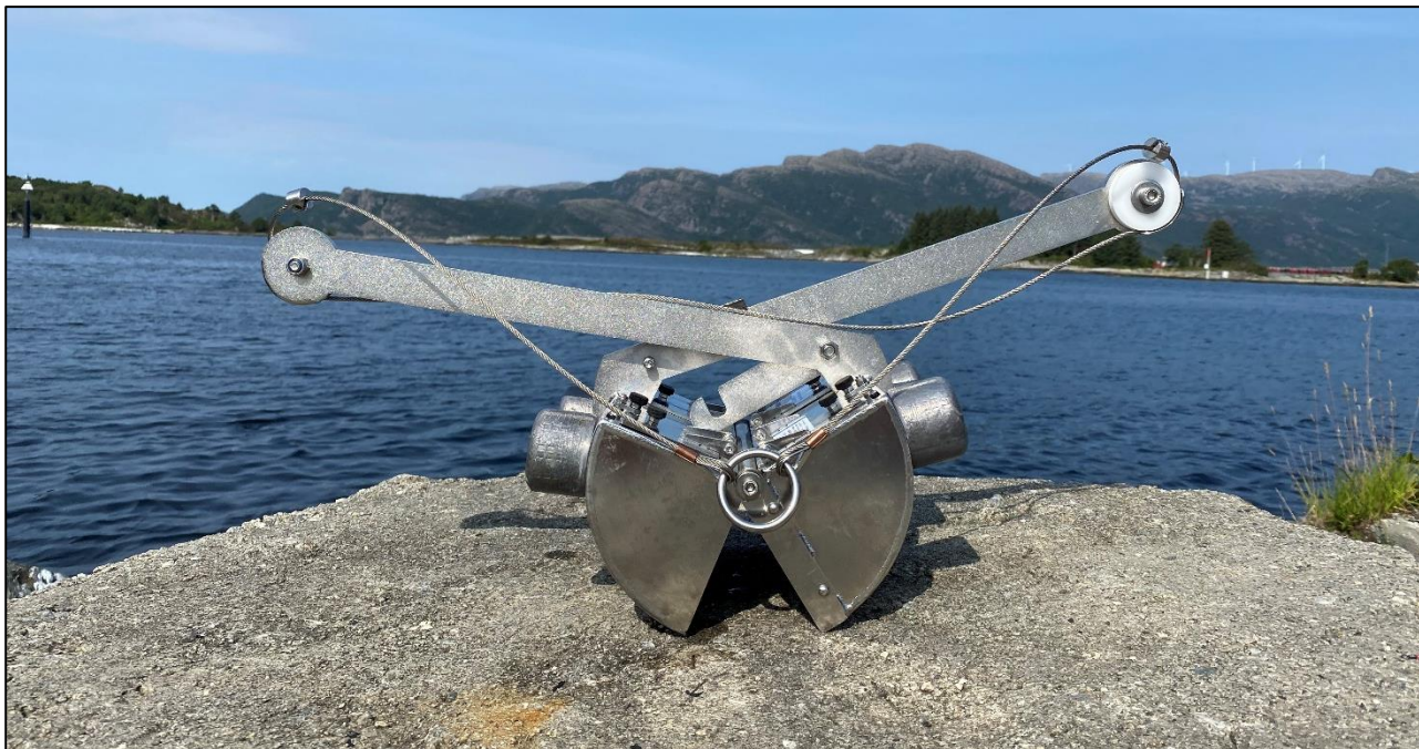
Figur 3: Van Veen sediment grab i str. medium som ble brukt til sedimentprøvetaking.
