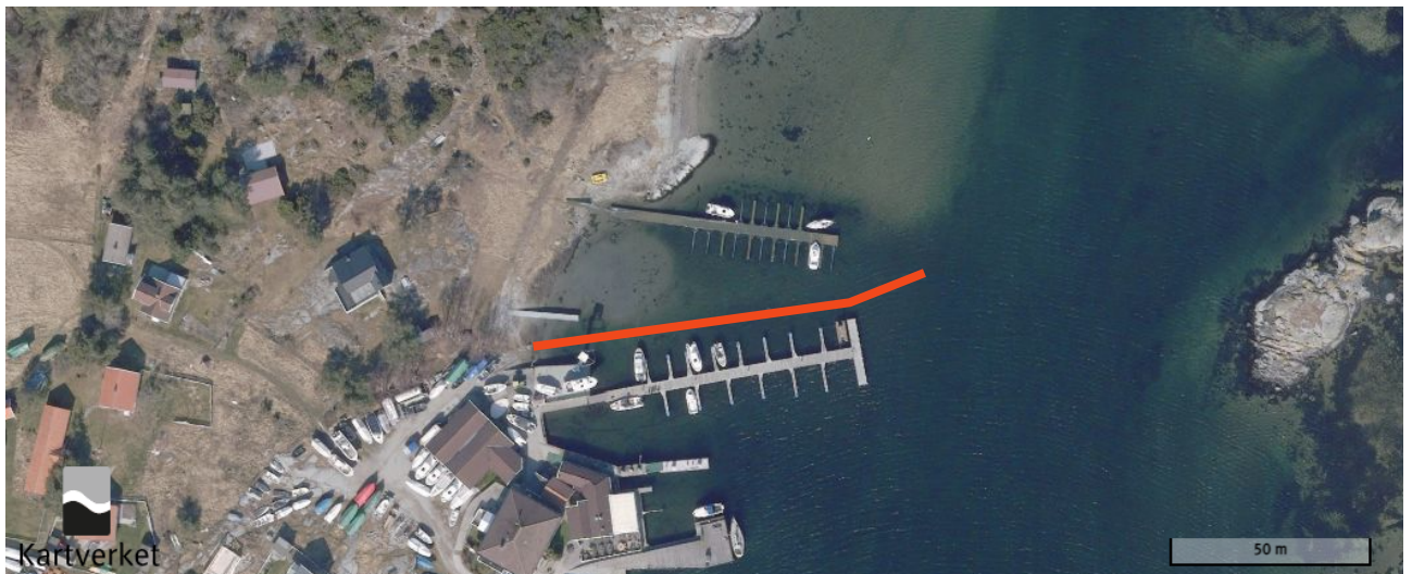
Figur 2. Figuren viser omtrentlig trasé for nedgravd vannledning ved Herføl Brygge. For nøyaktig trasé, se Figur 3.
