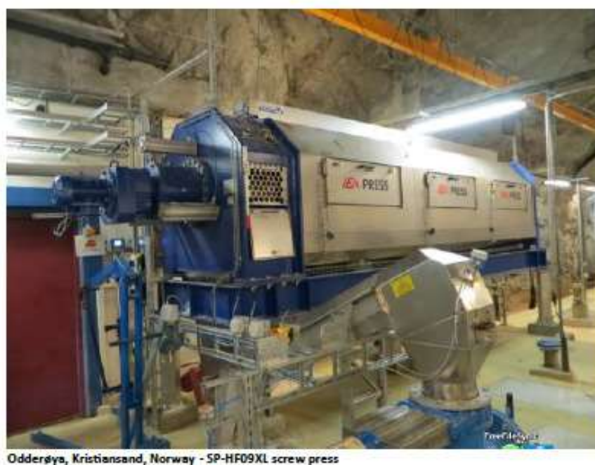
Figur 15: Tilsvarende skrupresse fra Odderøya RA (kilde: IEA)
