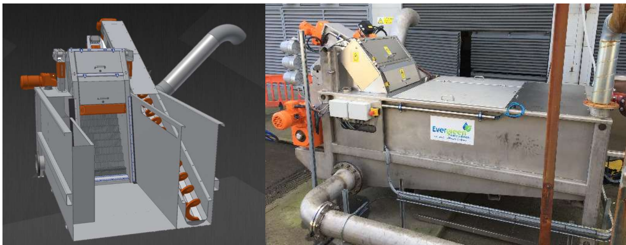
Figur 16: Eksempel på eksternslammottak lagt til grunn for forprosjektet (kilde: Andersson Water).
