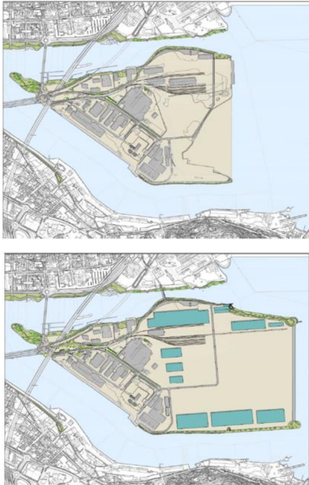
Figur 1. Prinsippkisser for første pågående utbyggingstrinn(øverst) og for planlagt byggetrinn(nederst). Fyllingskanten vil ligge inntil 1 km lenger ut enn dagens kaikant og er fremkommer ikke i figuren.
