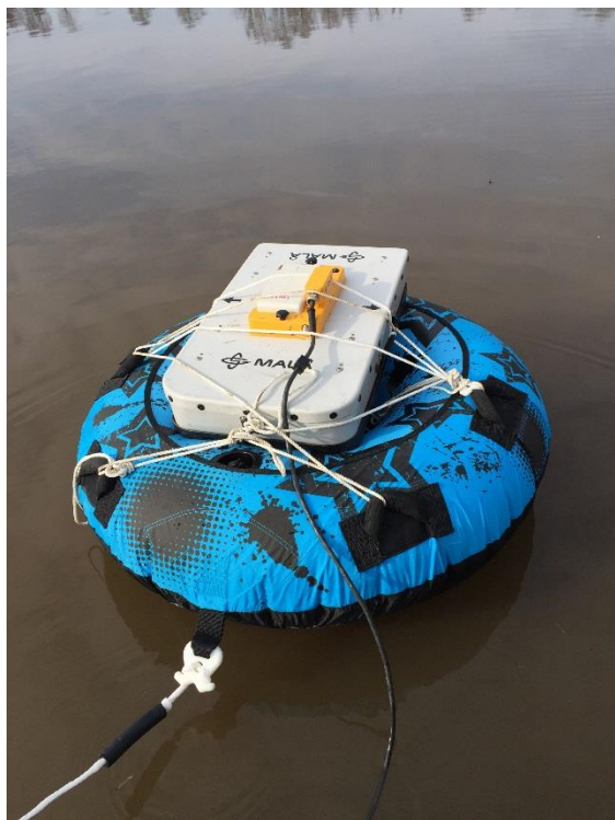
Figur 2. Georadarantennen plassert oppå en flytering som taues på siden av båten for å unngå signalstøy fra påhengsmotoren.
