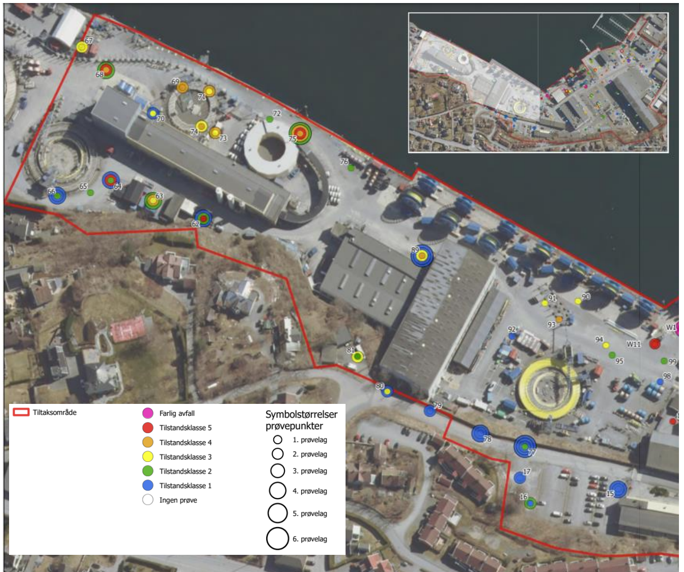
Figur 9. Resultater fra jordprøver tatt av DMR i 2021 og WSP i 2024 (markert W1-W11) hvis med flyfoto. Fargekoding iht. Miljødirektoratets helsebaserte tilstandsklasser og farlig avfall.
