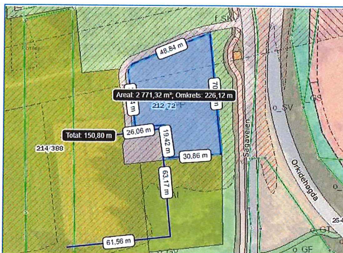
Figur 5: Angivelse av planlagt areal for snødeponi
