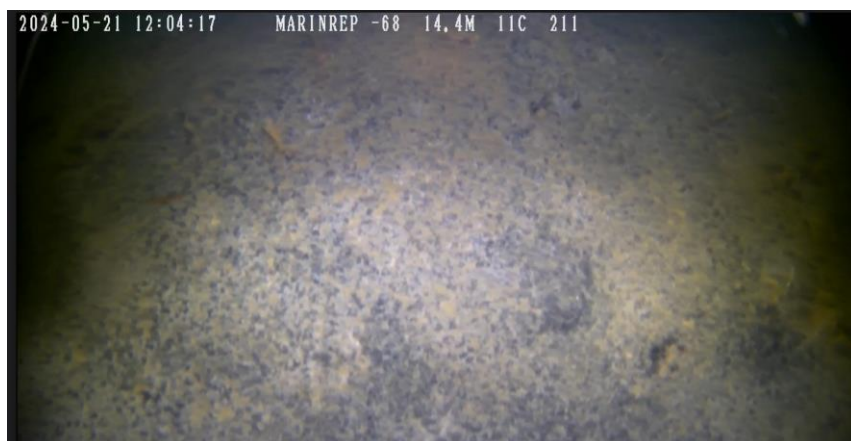
Figur 3-11. ROV-bilder fra transekt Spro4. Mudderbunn som i stor grad er dekket av bakteriekolonier. Dette er tegn på anoksiske forhold i bunnsedimentene. Mulig innslag av svamp.
