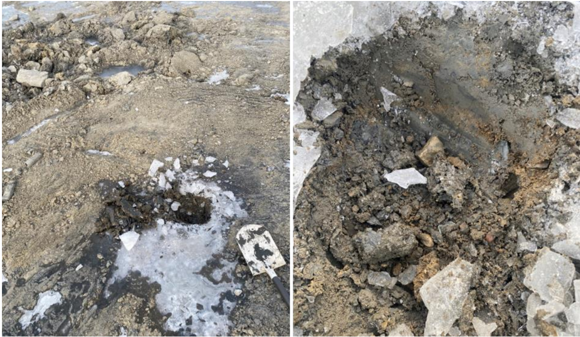
Figur 7. Prøve av de leirige massene som utgjorde P4-P6 som befant seg øst for Vorma.
