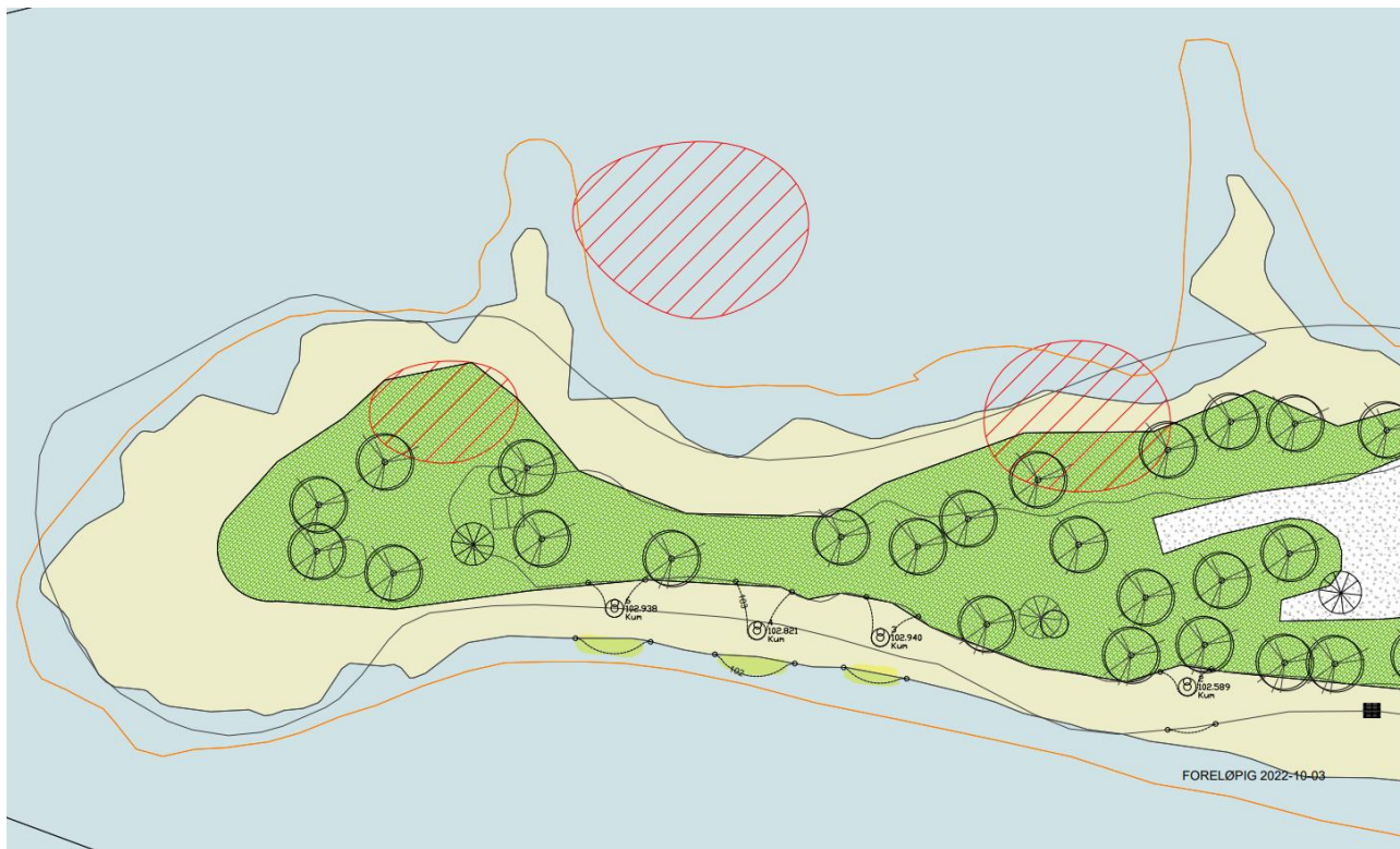
Figur 3: Plassering av de 3 kummene på Sandstangen. Gul markering viser til antatt område i Øyeren som kan forventes berørt av utfyllingen.
