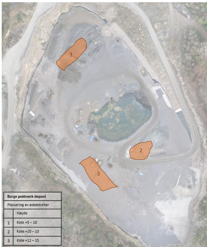
Figur 6: plassering av asbest i deponiet.
