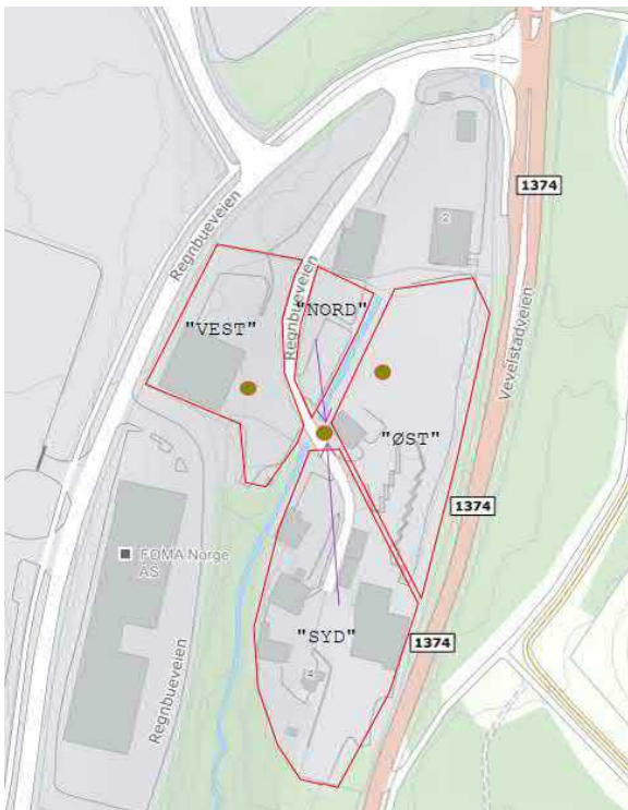
Oversikt over eksisterende oljeutskillere. Utskiller øst for bro skal saneres.
