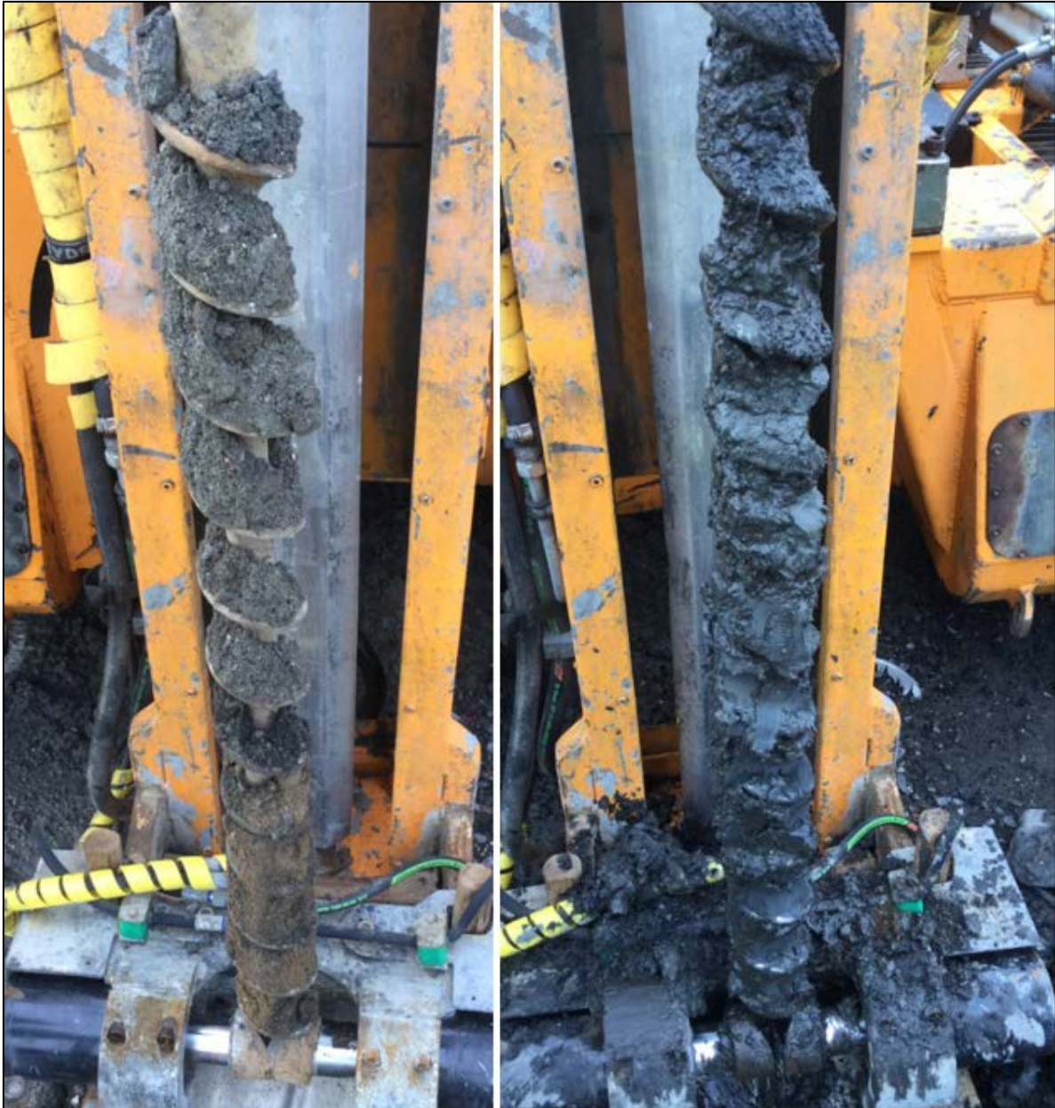
Figur 4. Bilder av jordprøver fra M28. Til venstre vises fyllmasser fra 0-1 m. Til høyre vises siltig leire fra 5-6 m.
