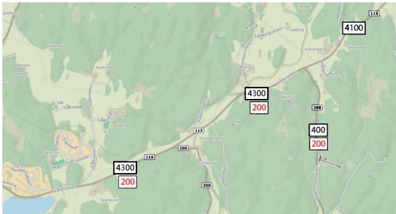
Figur 10: Estimert trafikkbelastning (ÅDT) i anleggsperioden langs Vålerveien og inn til skytebanen i Bjørnerødveien. Hentet fra SWECOs trafikkanalyse [4].
