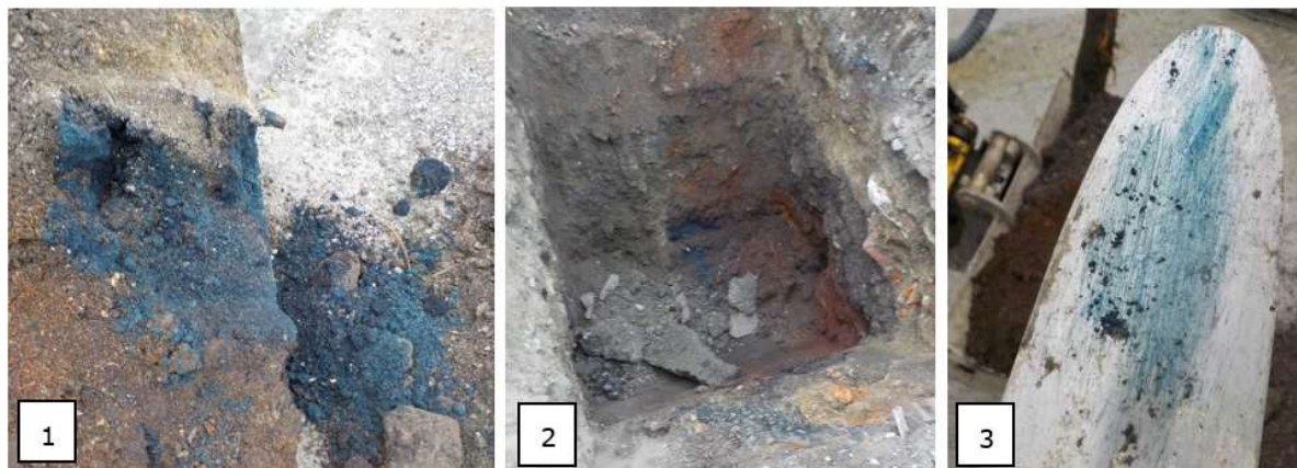
Figur 6: Bilder fra prøvetaking i prøvepunkt S3. Bilde 1 – Masser fra bunn av sjakten, i gravemaskinskuff. Bilde 2 – Prøvesjakt, ca. 1,5 m dyp, man ser blå masser i bunn av sjakten. Bilde 3 – Prøvetakingsspaden ble farget blå av de blåfargede massene.
