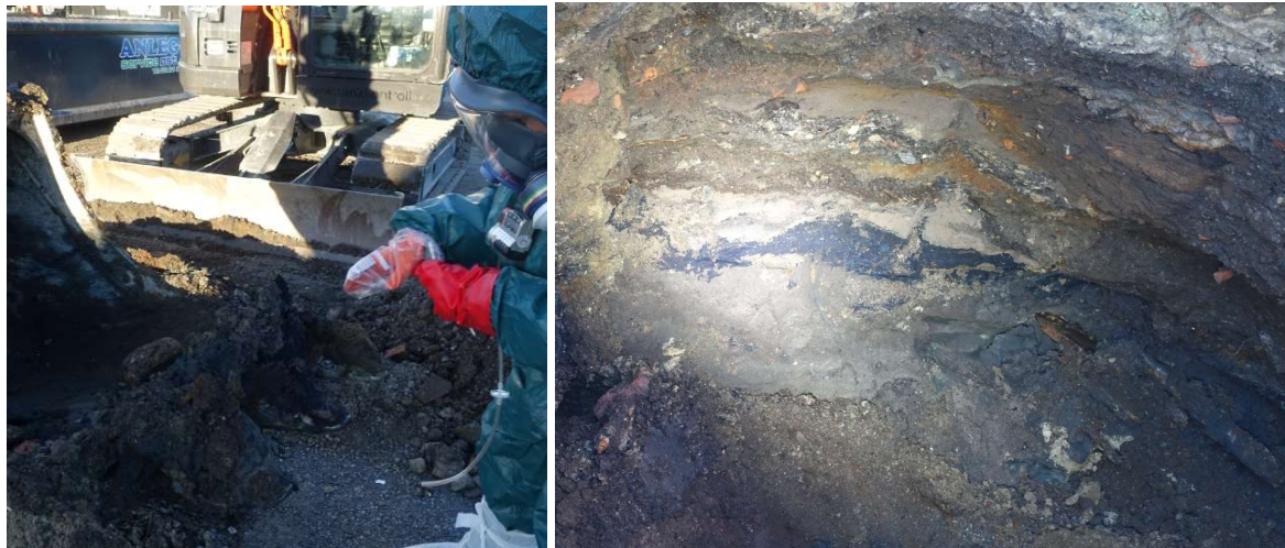
Figur 7. Bilde til venstre viser prøvetaking av masser fra skuff 20.11.2020. Bilde til høyre viser sjaktevegg mot sør-vest etter ferdig utgraving. Gjenværende blå masser synes som en linse midt i bilde.
