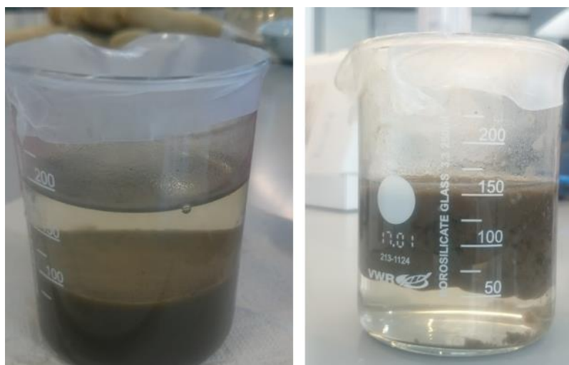
Figur 7: Slam fra biologisk rensing. Normal sedimentering til venstre, til høyre har det forekommet nitrifisering som resultat av lav belastning hvilket gav flyteslam.
