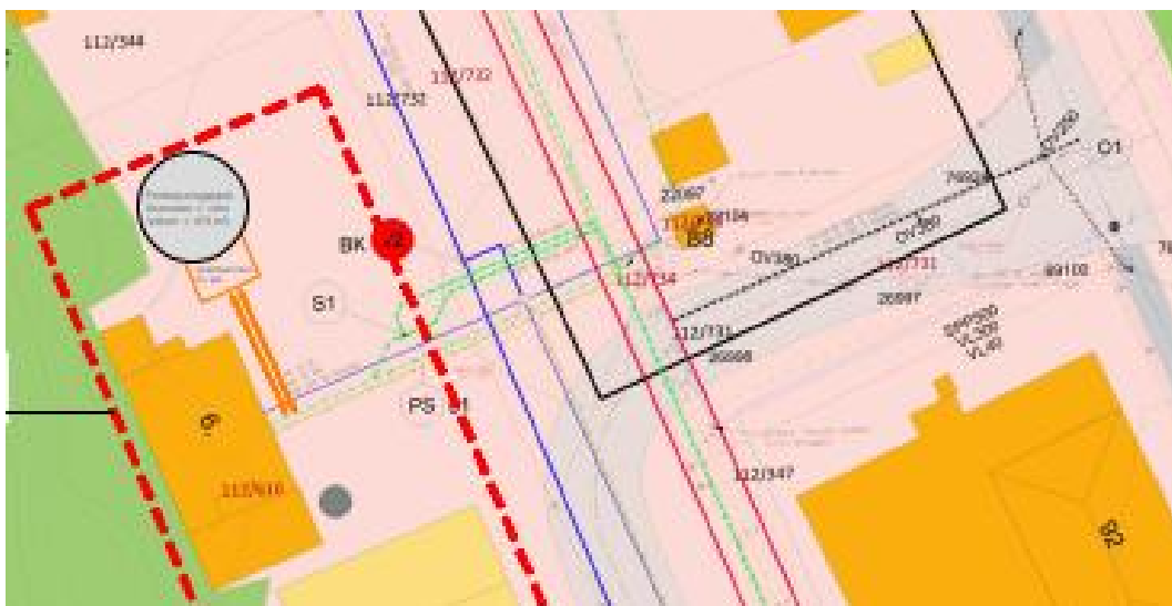
Figur 38. Forslag plassering av fordrøyningsbasseng.
