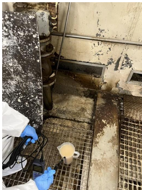
Figur 31. Oksygenmåling ved resirkulasjonsbassenget.
