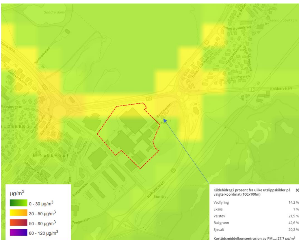
Figur 3-2. Kart som viser døgnmiddelkonsentrasjon for svevestøv (PM 10 ) sammenlignet med tiltaksgrensene i forurensningsforskriften (31. høyeste døgnmiddel). Tegnforklaringen nede i venstre hjørne viser konsentrasjonen av svevestøv (PM 10 ) i µg/m³. Konsentrasjoner over 50 µg/m³, dvs. rød sone, utløser krav til gjennomføring av tiltak. Tegnforklaringen nede til høyre viser kildebidragene ved nærmeste bolig til Mills. Bedriftsområdet til Mills er markert med rød stiplet linje. Kilde: Fagbrukertjeneste for luftkvalitet.
