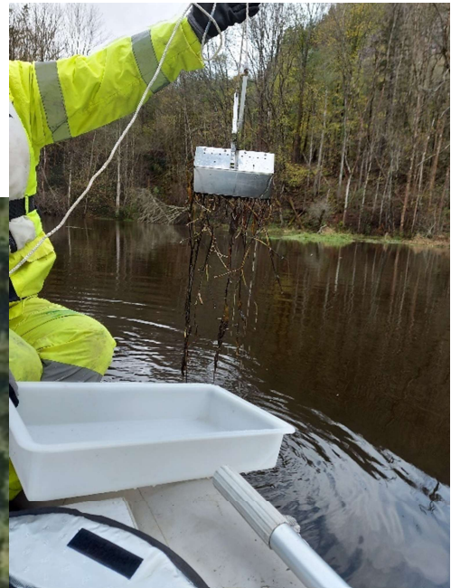
Figur 11 Mye organisk materiale og planterester i grabben som noen ganger førte til bomskudd fordi grabben ikke lukket seg tilstrekkelig.
