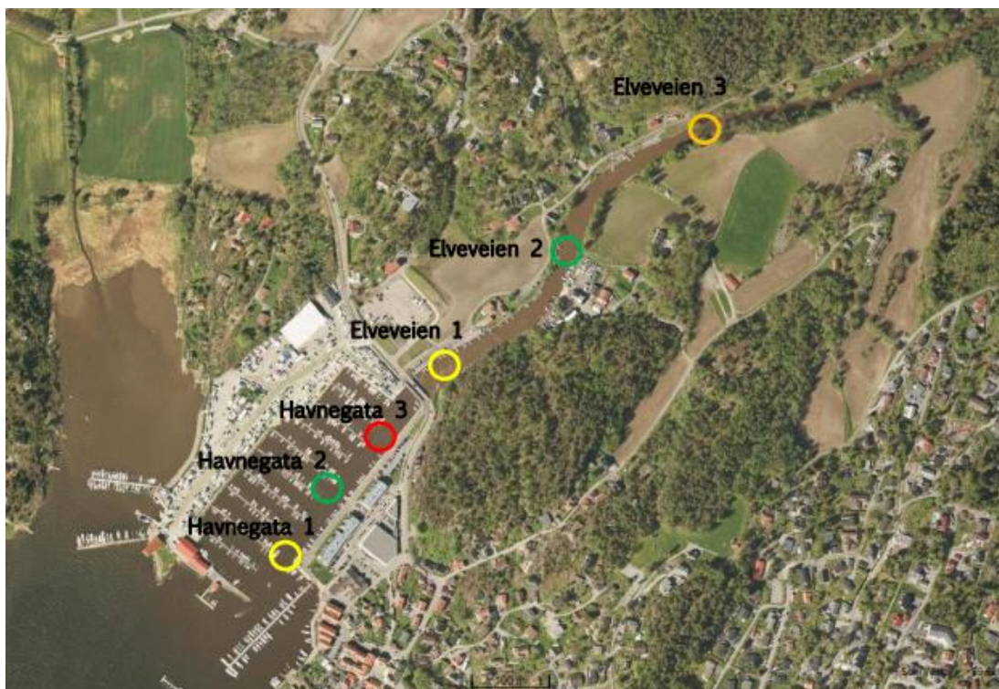
Figur 5. Utsnitt av flyfoto som viser entreprenør Arne Røs AS sin plassering av prøvepunktene i utløpet av Sånå (Havnegata 1-3) og videre oppover i nedre del av elveløpet (Elveveien 1-3) under prøvetaking vha. dykkere i 2019. Ringene rundt prøvepunktene er fargelagt iht. Miljødirektoratets tilstandsklasser i veileder M608/2016 etter en samlet vurdering av sedimentenes forurensningsgrad.
