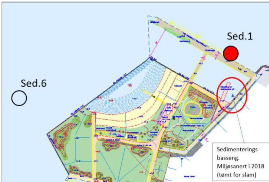
Fig. 9. Gjeldende plan for «Rabben» med angivelse av miljøsanert basseng. Ref. Utdrag fra tiltaksplan utarbeidet av Golder Associates AS, pr. 19.11.2020
