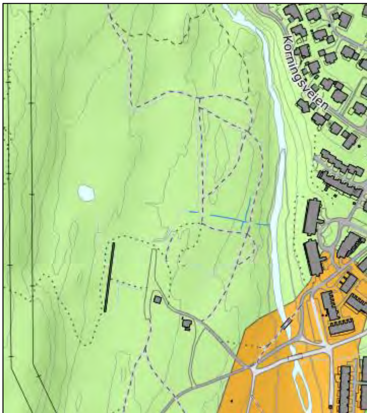
Figur 3. Løsmassekartet fra NGU viser at løsmassene på området består av et tynt morenelag over berg (grønn farge).
