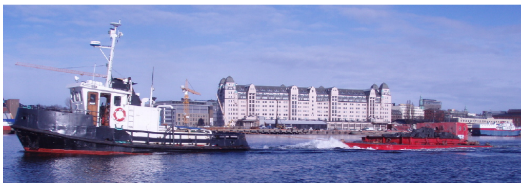
Figur 6 Lekter fylt med leirmasser under slep ut mot tildekkingsområdet
