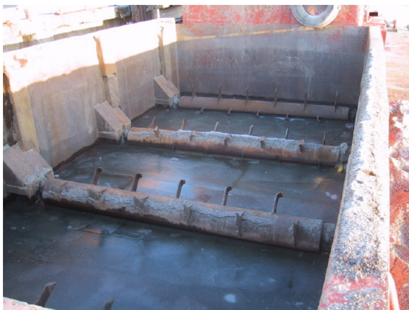
Figur 5 Foto av bunnen på den modifiserte lekteren som viser de roterende tromlene påmontert kniver for oppkutting av leirmassene
