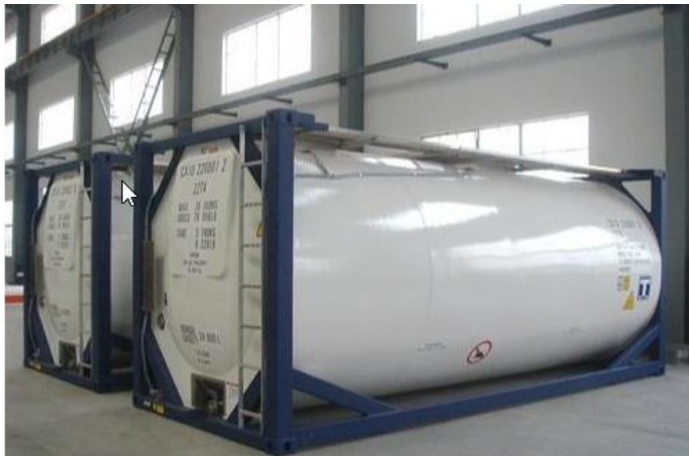
ISO tankcontainere for mellomlagring og transport av væsker på vei, jernbane eller skip.
