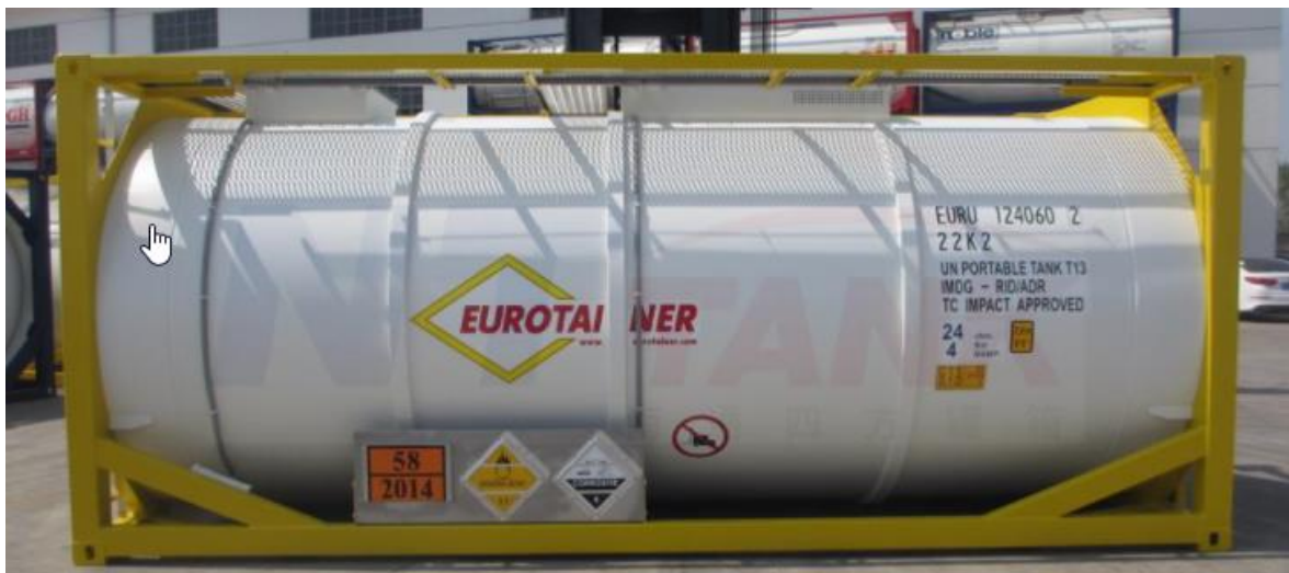
ISO tankcontainere for mellomlagring og transport av væsker på vei, jernbane eller skip.
