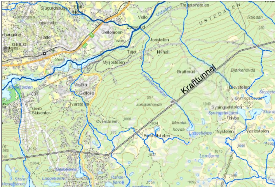
Figur 11. Krafttunnelen mellom Ustevatn og Kleivi (Kleivi kraftstasjon har utløp til Strandafjorden)
