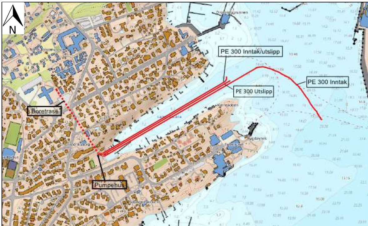
Figur 4. Skisse over trasé for sjøledningene som skal sirkulere vann til varmeutveksling. Fra ca. kote -5 legges ledningene på sjøbunnen ut til inntaket på ca. kote -20. Figuren er en skisse og viser ikke nøyaktig plassering av ledningene. Figuren er hentet fra Multiconsults notat 1011301-AB-RIV-NOT-04 (1).
