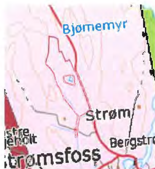
Fig. 4. Geologisk kart over området viser at hele planområdet består av harde bergarter som diorittisk til granittisk gneis, migmatitt (rosa farge). Planområdet er vist midt på kartet med tynn rød strek Kilde: www.ngu.no
