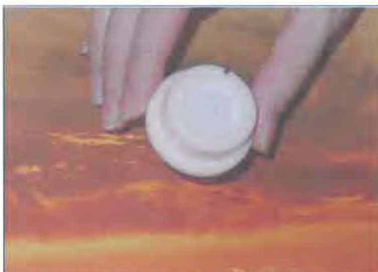
Figur 2. En DGT-enhet for akkumulasjon av metaller og metalloider.
