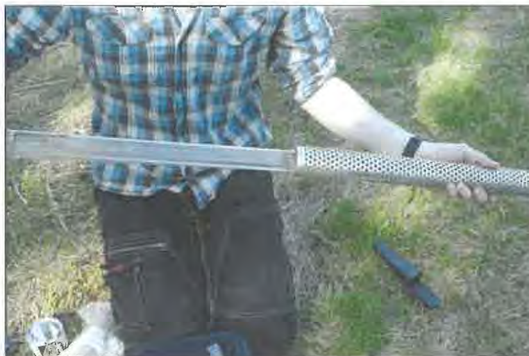
Figur 1. Montering av en SPMD-enhet for akkumulasjon av organiske forbindelser.
