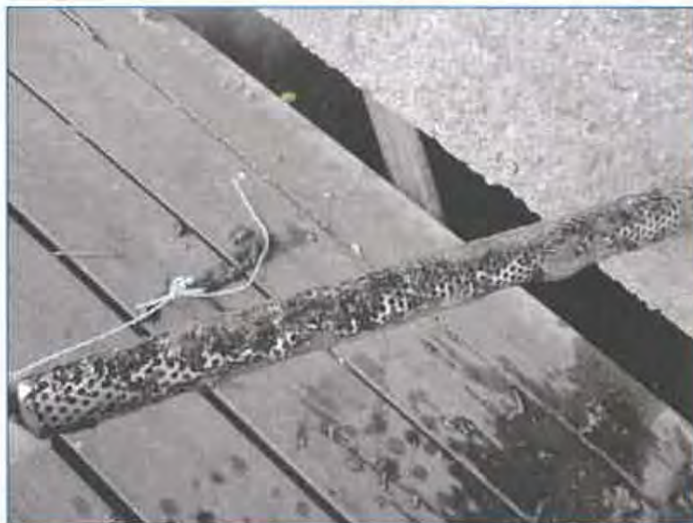
Figur 4. Kraftig tilslamming med slam og oljeforbindelser i prøvetakningsburet ved prøvepunkt 15 - Langbrygga,
