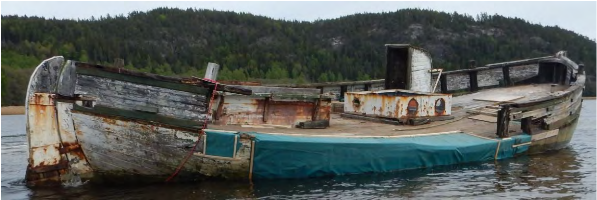
Figur 5. I tilfelle båten skulle ta inn vann, om den skulle krenge, ble skadene i skroget tettet med presenning. Foto: Ola Wergeland Krog.
