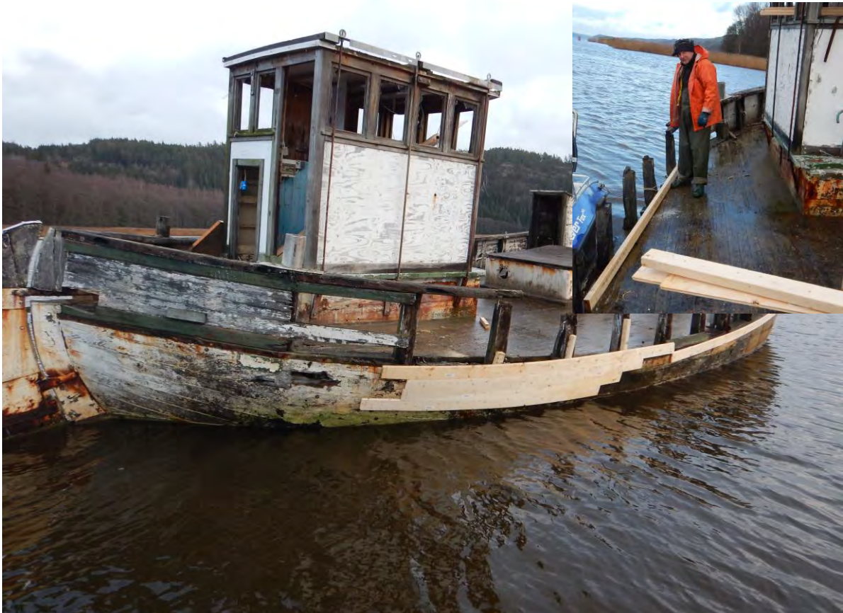
Figur 3. Wirgo hadde skader i skroget slik at den tok inn vann da den skulle lenses. Skadene måtte derfor laskes. Innfelt bilde med altnuligmann Even Rud som hjalp til med den første tømningen. Foto: Ola Wergeland Krog.
