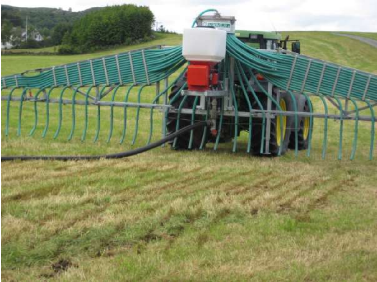
Foto: Anne Grete Rostad. Spreieutstyr for nedlegging av husdyrgjødsel med slangetilkopling til gjødsellager
