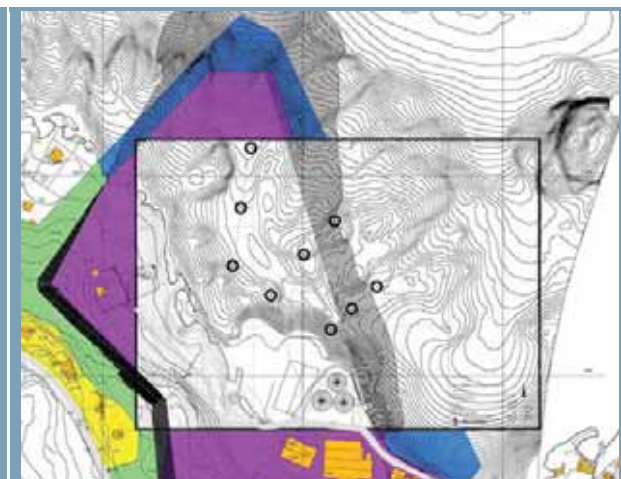
Figur 85: Grunnundersøkelser i sjø ved hjelp av boring/sondering, ref. skisse til nytt planforslag, Multiconsult AS-2009/Norconsult AS 2014,
