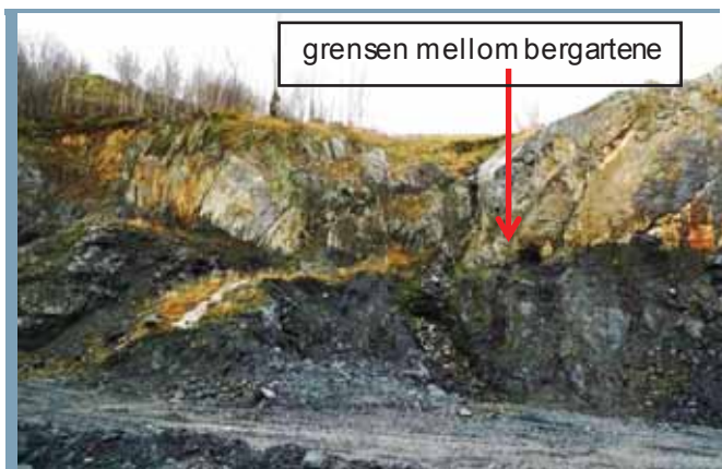
Figur 78: Grensen mellom den mørke fyllitten og den lyse gneisen har utgående i eksisterende bergvegg, Multiconsult nov. 2014
